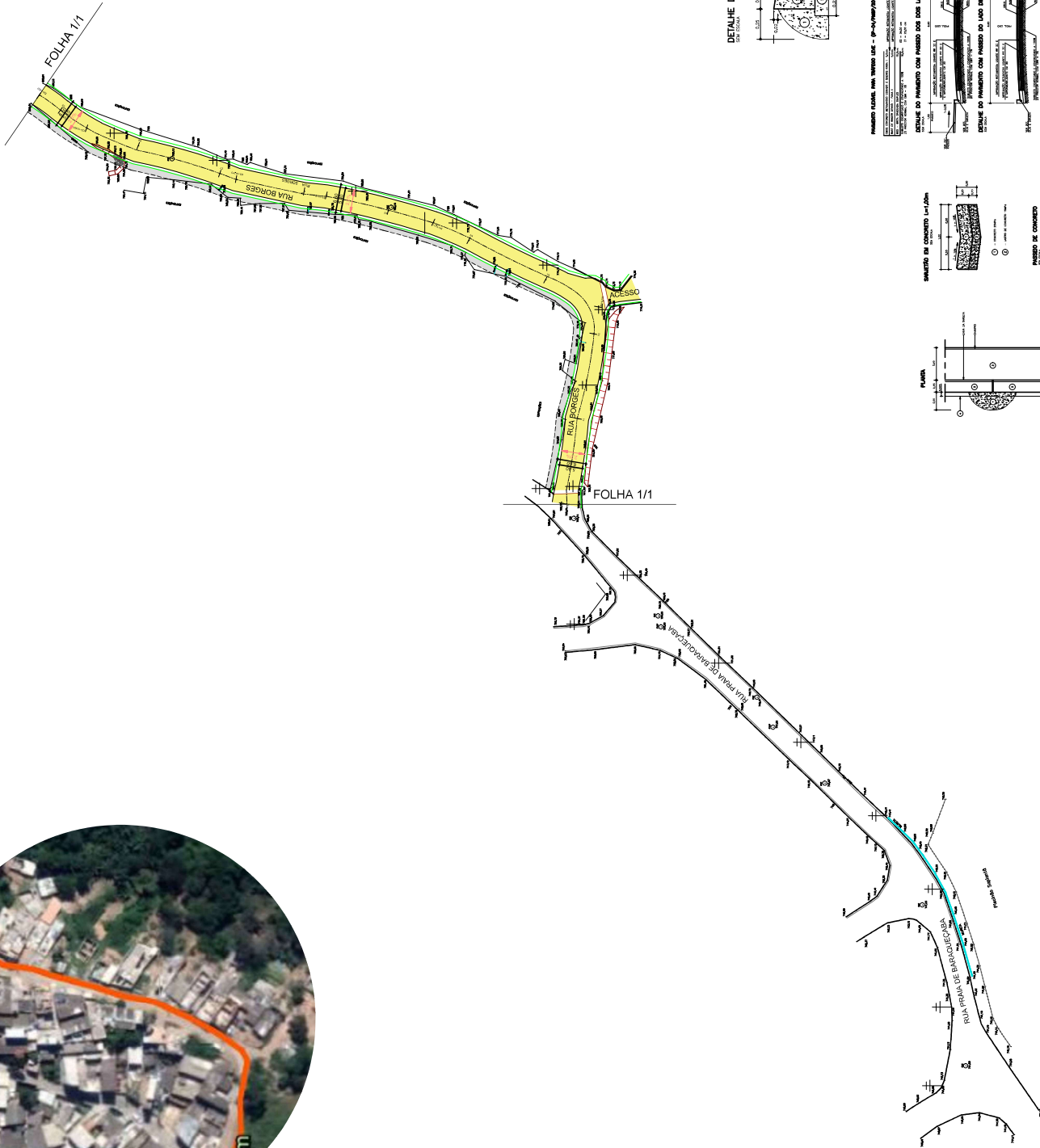
PAVIMENTO DE CONCRETO: PAV. TRINCO 0,45m - (P=4,5m/2,0m)
